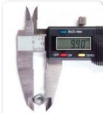
الشكل 11 يُستخدم المقياس العنقي الرقمي للتحقق من حجم صامولة حتى جزء من المئة من المليمتر (0.01 mm). إن المهارة مطلوبة لتحديد وضع الجزء في المقياس العنقي بصورة صحيحة. سيحصل الميكانيكيون أصحاب الخبرة على قراءات أكثر دقة من الميكانيكيين غير الخبراء.
