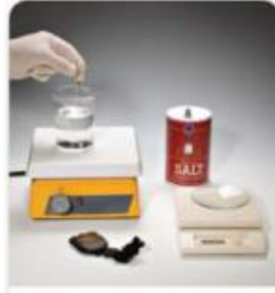
الشكل 11 يمكن استخدام هذه المواد لتحديد تأثير درجة الحرارة على معدل ذوبان ملح الطعام.
