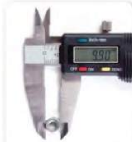
الشكل 11 يستخدم البعاس العنقي الرقمي للتحقق من حجم صامولة حتى جزء من المئة من المليمتر (0.01 mm). إن الميزة المطلوبة لتحديد وضع الجزء في البعاس العنقي بصورة صحيحة، سيحصل الميكانيكيون أصحاب الخبرة على قراءات أكثر دقة ودقة من الميكانيكيين غير الخبراء.
