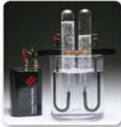
الشكل 16 إنَّ الماء مستقر، لكن عند تمرير تيار كهربائي خلاله، ينحلل الماء لينتج الهيدروجين والأكسجين.
