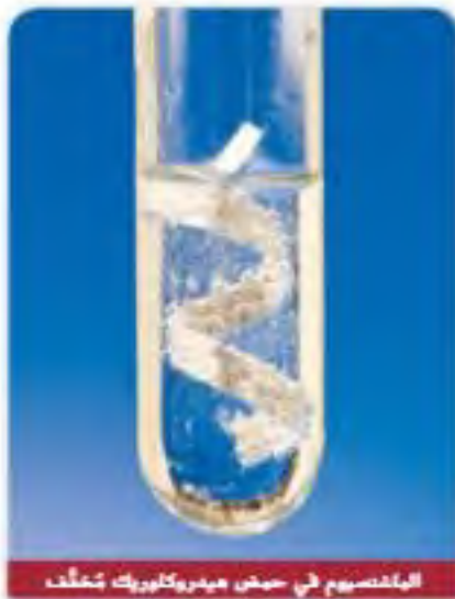
الشكل 19 تزيد سرعة التفاعل بين المغنسيوم وحمض الهيدروكلوريك عند زيادة تركيز الحمض.
