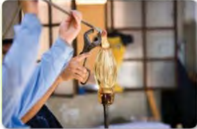
الشكل 11 ينفجر الزجاج إلى البنية البلورية المتكررة في المواد الصلبة مثل الثلج. فبدلاً من الانصهار عند درجة حرارة محدّدة، يصبح الزجاج ليّناً ومرناً بشكل متزايد كلما ارتفعت درجة الحرارة.
