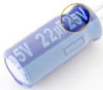
الشكل (٣-١٧) : أكبر فرق جهد يمكن توصيله بين طرفي أحد المواسعات.
