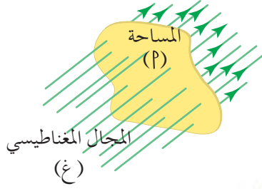
الشكل (١-٦): مفهوم التدفق المغناطيسي عبر سطح معين.
