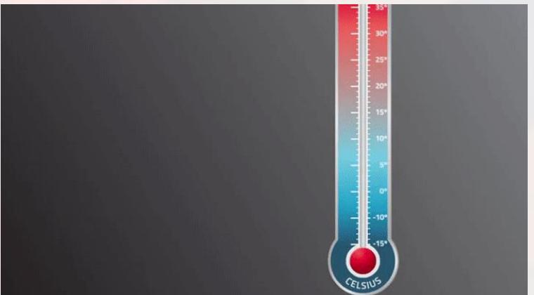
يمكنك رؤية تمدد المادة أو انكماشها في مقياس درجة الحرارة. إن مقياس درجة الحرارة (الثيرmomتر) هو أداة لقياس درجة الحرارة. تُوضع بعض مقاييس الحرارة من أنبوب شفاف مملوء بسائل، وعندما ترتفع درجة حرارة السائل، فإن السائل يتمدد. فيرتفع ويملاً مساحة أكبر من الأنابيب، وعندما تقل درجة حرارة السائل، فإن السائل ينكّمّش ويشغل حيزاً أقل في الأنابيب.
