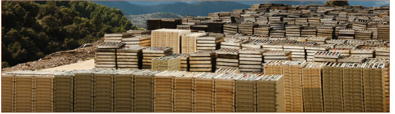
الشكل 3-31 عيّات جوفية محفورة لتعطي صورة عن الطبقات تحت السطح.
