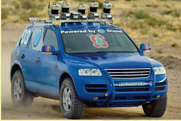
الشكل 1 ستانلي، المركبة ذاتية التحكم التي صممها فريق من جامعة ستانفورد والفائزة بالتحدي DARPA Grand Challenge لعام 2005.
