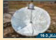
الشكل 16-3 مرآة مقعرة كبيرة يمكن أن تُستخدم في غلي الماء في الإبريق.
