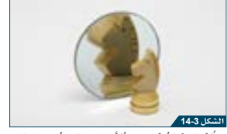
الشكل 15-3 تكون المرآة المحدبة صورة مقلوبة للجسم الذي يوضع قريبًا. الشكل 14-3 تكون المرآة المقعرة صورة مكبرة للجسم الذي يوضع قريبًا.
