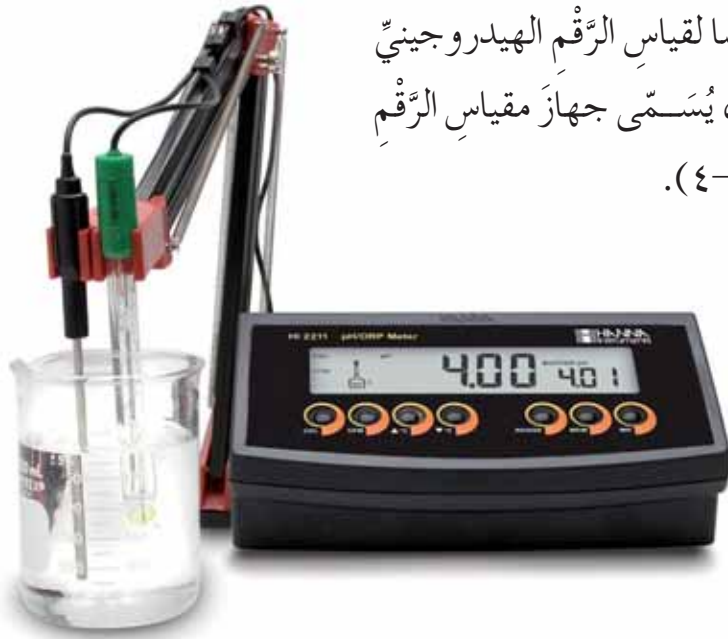
الشَّكْلُ (٤-٤): جهازُ مقياسِ الرِّقْم الهيدروجينيّ.
