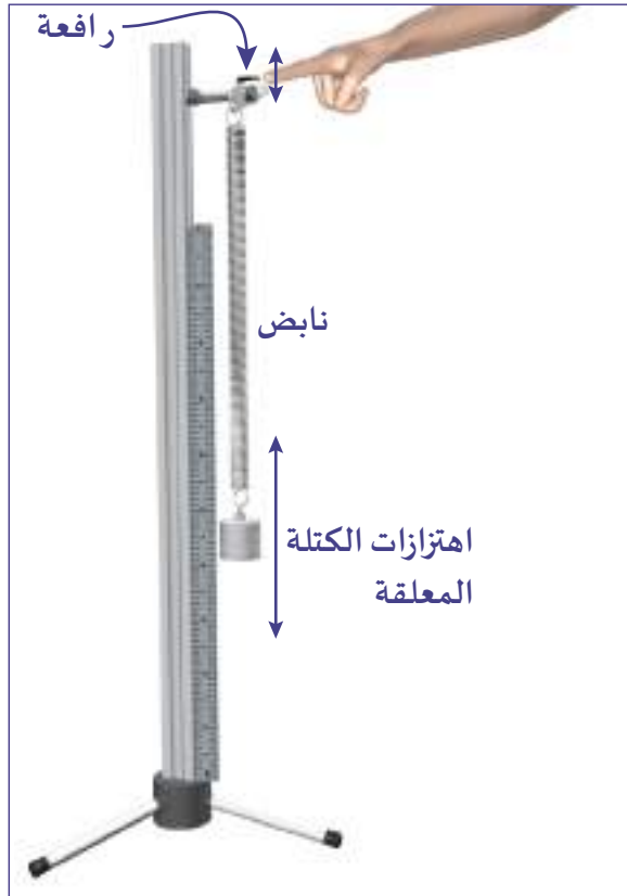
الشكل 2-45 اهتزاز كتلة معلقة في نابض.
