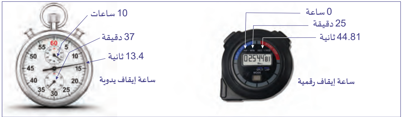
الشكل 9-1: كيفية قراءة ساعة الإيقاف اليدوية وساعة الإيقاف الرقمية.
