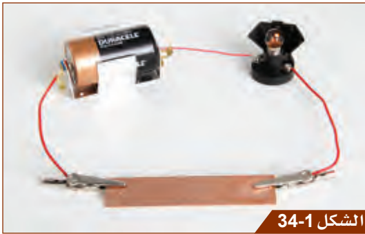
استخدم هذه الدائرة الكهربائية لاختبار التوصيل الكهربائي.
