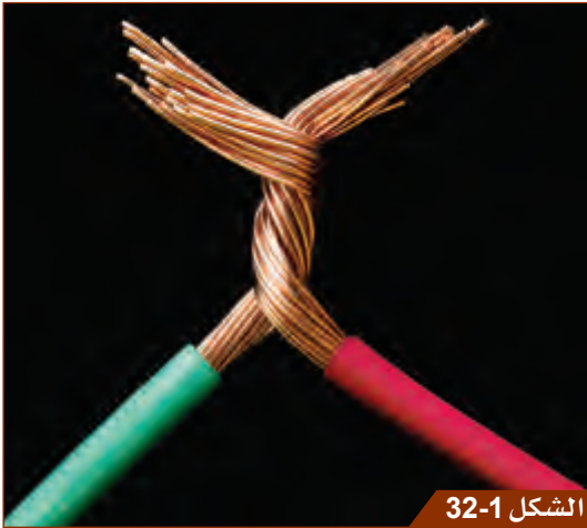
الشكل 32-1 تُصنع الأسلاك الكهربائية من النحاس، لأنه موصّل جيد للتيار الكهربائي.
