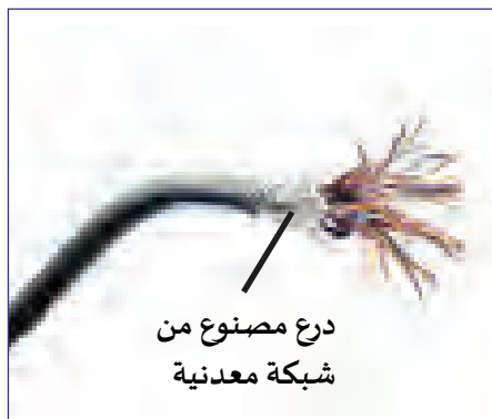
الشكل 3-22 حماية سلك الحاسوب باستخدام درع معدني.
