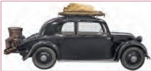
الشكل 17-6 سيارة قديمة تم تصميمها لتعمل بالغاز المصنَّع الناتج عن الخشب.
