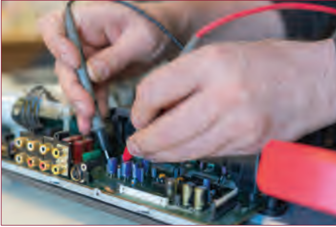
الشكل 7-16 تشخيص للخطأ في جهاز كهربائي.
