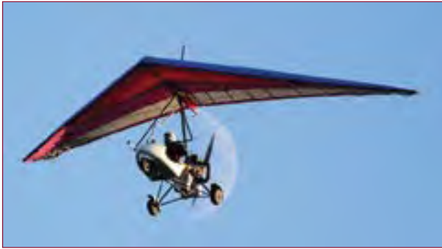
الشكل 28-6 طائرة خفيفة جداً مع دعائم قوية، لكنّها جوفاء.
