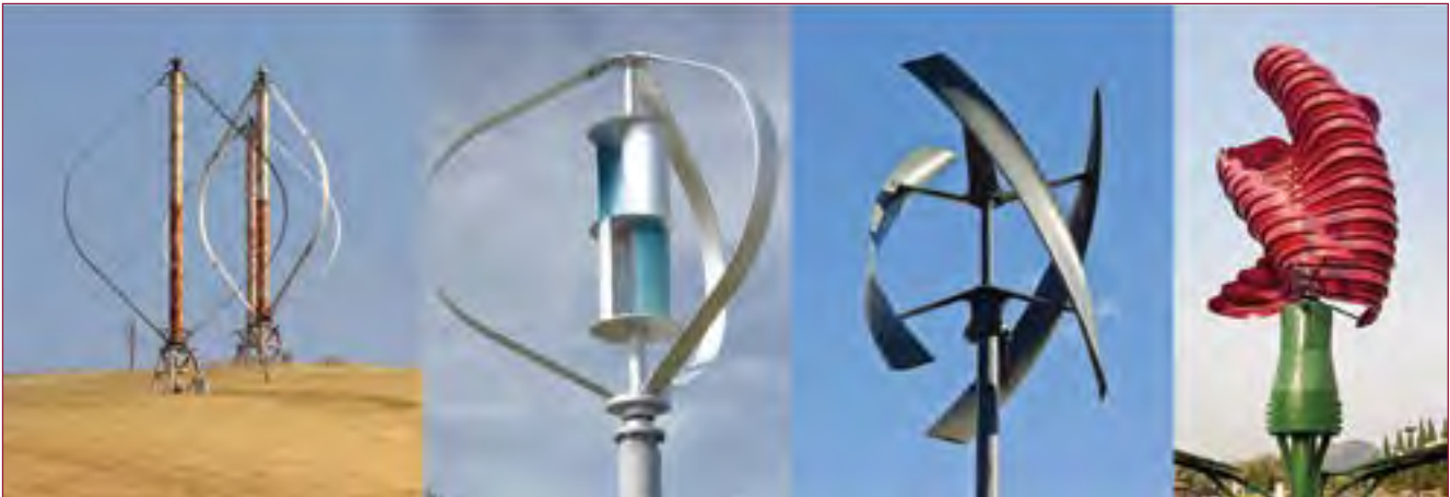
الشكل 9-17 توربينات الرياح ذات المحور الرأسي باستخدام كل من الأجنحة وتصميم سافينوس الشائع.
