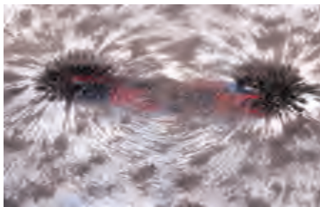
الشكل (1) تخطيط المجال المغناطيسي باستخدام بُرادة الحديد
