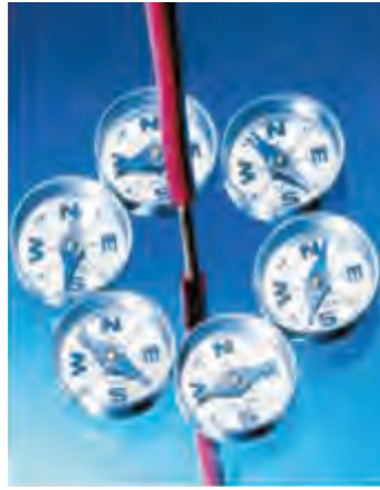
الشكل (3) اتجاه المَجَالِ المَغْنَطِيسِي حول سلك مستقيم
