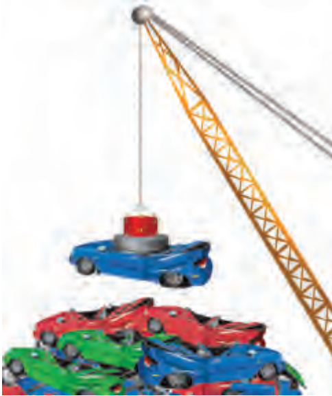
الشكل (8) تستخدم الرافعة الكهرومغناطيسية في رفع المواد المصنوعة من الحديد
