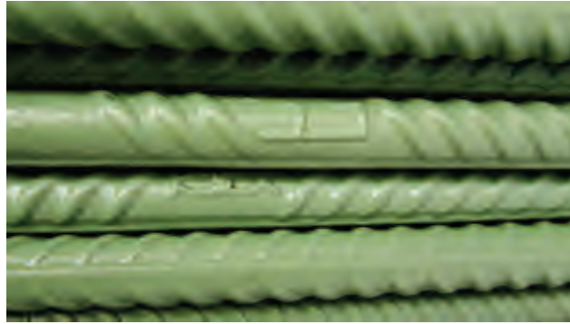
لاحظ الشكل (2) صورة لقضبان حديدية معزولة بطبقة من البلاستيك
