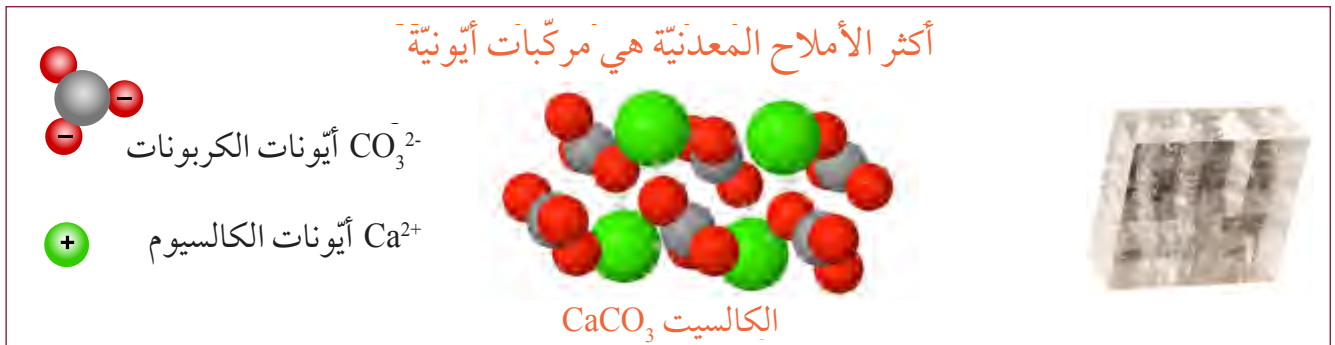
الشكل 53-2 الكالسيت مركّب أيونيّ يتكوّن على شكل صلب بلّوريّ.
