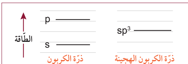
الشكل 21-2 مستوى طاقة الأفلاك s، p في ذرة الكربون مقارنة بطاقة أفلاك sp^3 المهجنة في ذرة الكربون.
