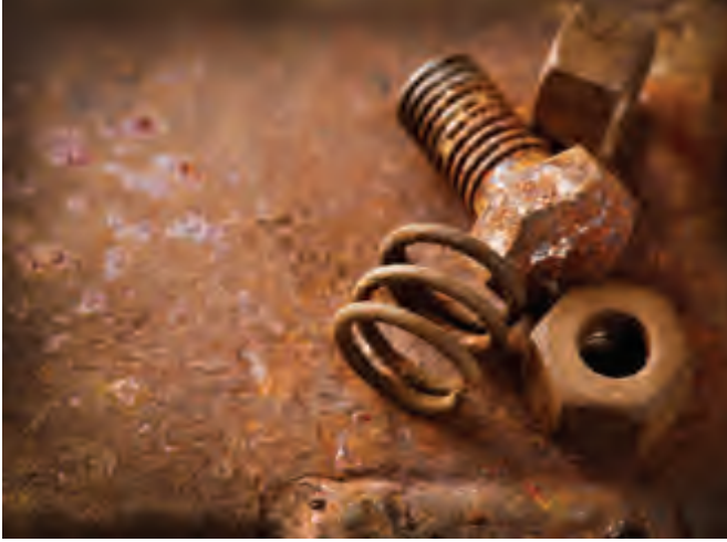
الشكل 13-3 الصدأ هو أكسيد الحديد (III) المائي وصيغته
