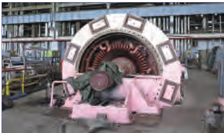
الشكل 22-5 مولّد كهربائي صناعي مفكّك للصيانة.
