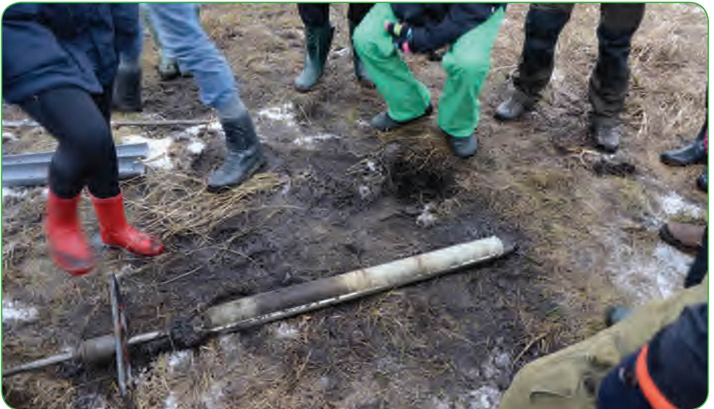
الشكل 5-35: عمليات الحفر في الأراضي الخثية للحصول على عينات لب الجفت
