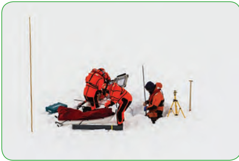
الشكل 31-5: عمليات الحفر في عام 2013 في أنتاركتيكا للحصول على عينات لب الجليد.
