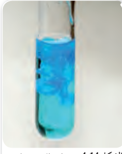
الشكل 14-4 عندما يضاف هيدروكسيد الصوديوم إلى محلول كلوريد النحاس II CuCl_2 ، تتبادل أيونات OH^- و Cl^- مواقعهما، وينتج عن التفاعل كلوريد الصوديوم الذي يبقى في المحلول، وهيدروكسيد النحاس II Cu(OH)_2 الذي يترسب على شكل مادة صلبة زرقاء اللون.
