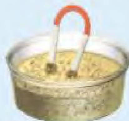
**المغناطيس:** لفصل الرمل عن برادة الحديد
