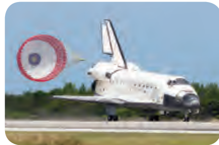
مُقاومة الهواء للمظلة تساعد المكوك الفضائي على التوقف.
