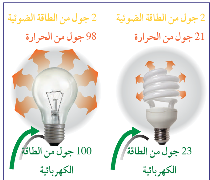
الشكل 34-3 مقارنة بين المصباح المتوهّج ومصباح الفلورسنت.
