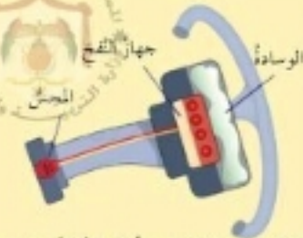
الشكل (٣-١٢): الوسادة الهوائية قبل وقوع الحادث.
