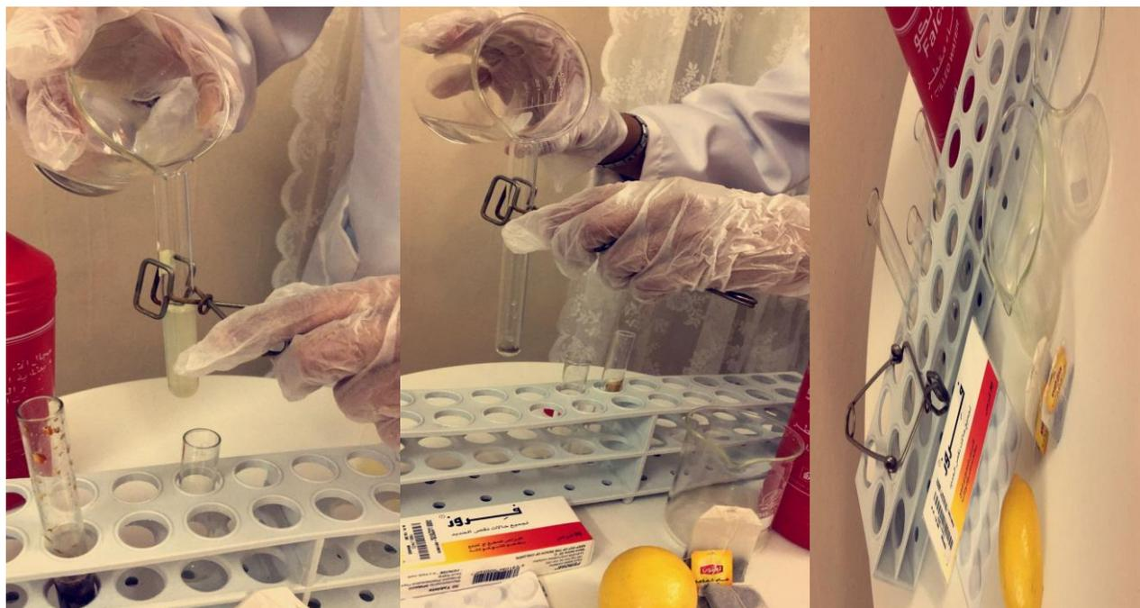
أولا : حضر محلول من كلوريد الحديد الثلاثي كما يلي: ضع ١٠ جرامات من ملح كلوريد الحديد الثلاثي في كأس سعة ٢٠٠ ملل صف شكل مادة كلوريد الحديد الثلاث جهاز ٥٠ مل من الماء المقطر في مخبر مدرج ١٠٠ مل (أو أي مخبر تزيد سعته عن ٥٠ مل) انقل الماء المقطر من المخبر المدرج إلى كأس كلوريد الحديد الثلاثي ، وحرك المزيج لمدة دقيقة ، صف ما تلاحظه؟ غط الكأس بواسطة زجاجة ساعة، وأحفظ المحلول في مكان مناسب.
