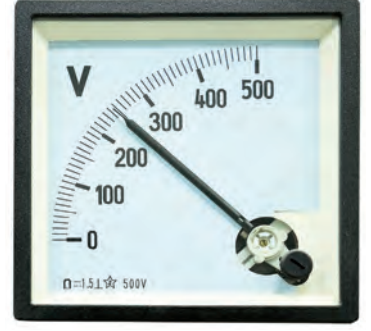
■ الشكل 4-4 يستخدم جهاز الفولتميتر لقياس فرق الجهد الكهربائي بين نقطتين.
