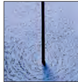
■ الشكل 10-8 يظهر المجال المغناطيسي حول سلك يمر فيه تيار كهربائي ويخترق قرصاً كرتونياً في صورة دوائر متحدة المركز من برادة الحديد حول السلك.
