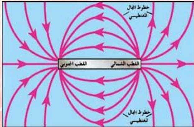
يمكن تمثيل المجال المغناطيسي الموجود حول المغناطيس باستخدام برادة الحديد. فكل قطعة صغيرة من برادة الحديد تصبح مغناطيساً بواسطة الحث، مثل إبرة البوصلة تماماً، وتدور برادة الحديد حتى تصبح موازية للمجال المغناطيسي.
