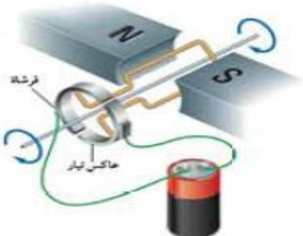
الحرك الكهربائي، وهو جهاز يستخدم لتحويل الطاقة الكهربائية إلى طاقة حركية دورية
