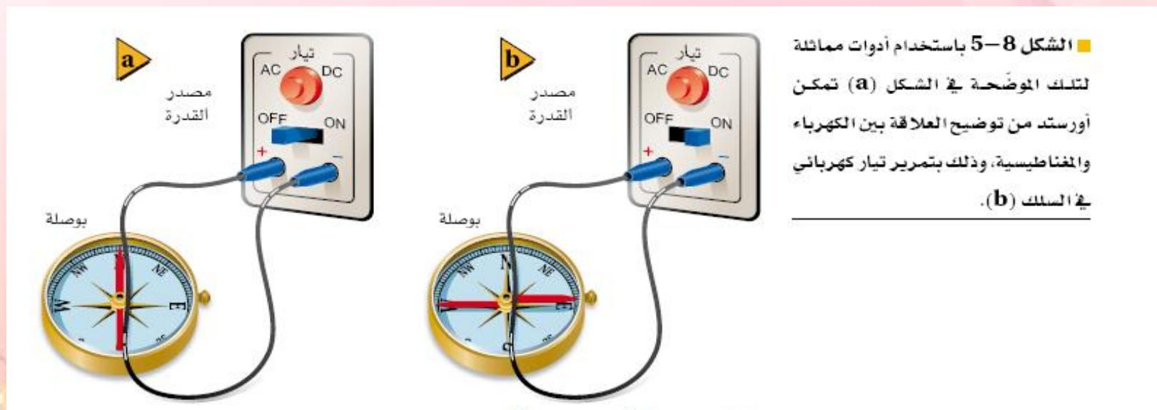
تناسب شدة المجال المغناطيسي المولد حول سلك مستقيم وطويل طردياً مع مقدار التيار الماء في السلك ، وعكسياً مع البعد عنه . وتبين البوصلة اتجاه خطوط المجال ، وإذا عكس اتجاه التيار فستعكس إبرة البوصلة اتجاهها أيضاً .
