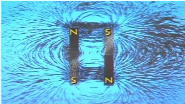
ويمثل المجال المغناطيسي بخطوط وهمية تسمى خطوط المجال المغناطيسي (خطوط الحث المغناطيسي ) ، وتشكل بجموعها ما يعرف بالطيف المغناطيسي .
