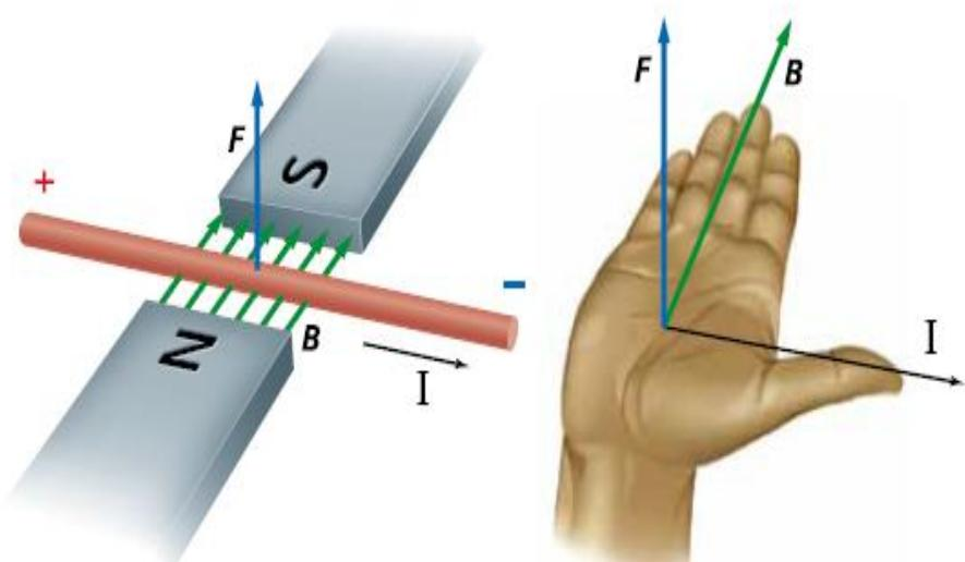
الشكل 16-5 يمكن استعمال القاعدة الثالثة لليد اليمنى لتحديد اتجاه القوة عند معرفة اتجاه كل من التيار الكهربائي وال المجال المغناطيسي.
