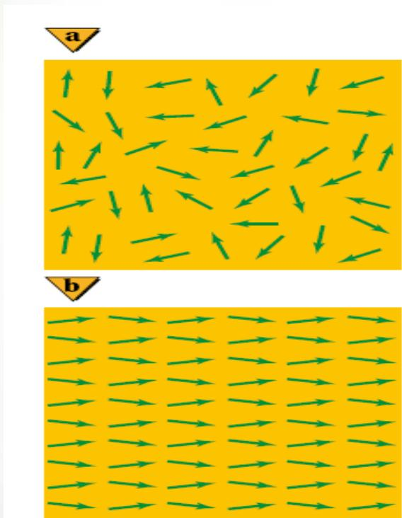
عندما لا تكون قطعة الحديد داخل مجال مغناطيسي فإن المنشآت المغناطيسية تكون في اتجاهات عشوائية، وتلغى مجالات المغناطيسية بعضها البعض، أما عندما توضع قطعة الحديد داخل مجال مغناطيسي فإن هذه المنشآت المغناطيسية تترتب بفعل المجال الخارجي لتصبح متفرقة معه في الاتجاه.
