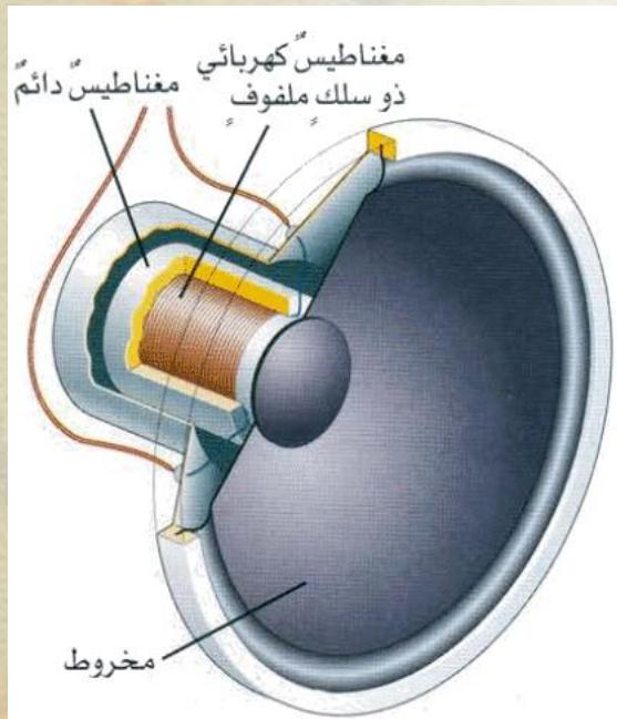
تعد مكّرات الصوت إحدى التطبيقات العملية على القوة المؤثرة في سلك يحمل تياراً كهربائياً يمر في مجال مغناطيسي. تعمل السمعاء على تحويل الطاقة الكهربائية إلى طاقة صوتية باستخدام ملف من سلك رفيع مثبت فوق مخروط ورقي، وهذا المخروط موضوع في مجال مغناطيسي. يرسل المضخم الذي يشغل السمعاء تياراً كهربائياً خلال الملف، ويتغير اتجاه هذا التيار بين  $20$  و  $20,000$  مرة في الثانية، وذلك وفقاً لحدة الصوت الذي يمثلها.
