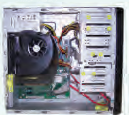
شكل (٤-٢): اللوحة الحاضنة داخل صندوق الحاسب
