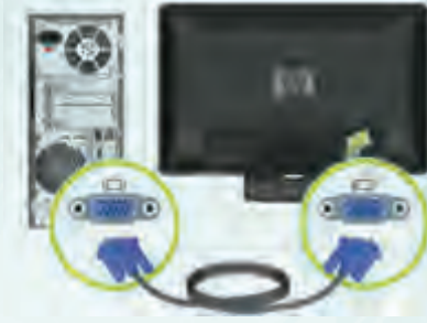
شكل (٨-١-٢): توصيل سلك الشاشة بالمنفذ المناسب له خلف صندوق الحاسب
