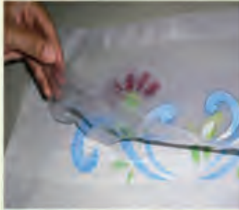
شكل (٨٨) : طباعة التفريغ بأكثر من لون بوجود الفواصل
