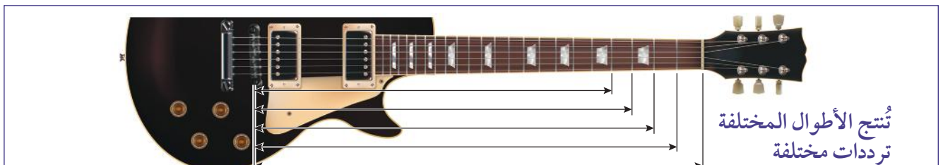
الشكل 6-53 يتم ضبط تردد الجيتار بتغيير طول وتره المهتز.
