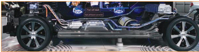
الشكل 4-26 خلية وقود في السيارة.
