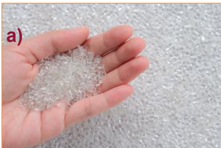
الشكل 6-46 البوليستر (a) كريات قبل عملية الغزل، (b) ألياف تستخدم في الوسائد، (c) لفافات معدة كي تنسج قماشًا.
