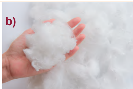
الشكل 6-46 البوليستر (a) كريات قبل عملية الغزل، (b) ألياف تستخدم في الوسائد، (c) لفافات معدة كي تنسج قماشًا.
