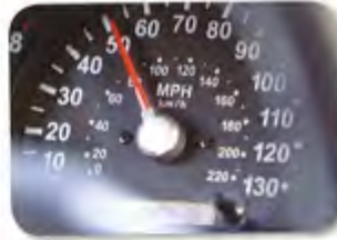
الشكل 6 يقوم عداد السرعة بعرض السرعة اللحظية للسيارة والسرعة اللحظية هي السرعة في لحظة زمنية واحدة.
