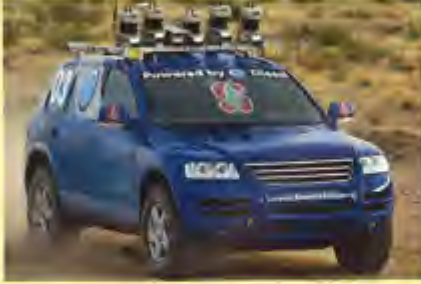
الشكل 1 سنابلي. المركبة ذاتية التحكم التي صممها فريق من جامعة ستانفورد والعاثرة بالتحدي DARPA Grand Challenge لعام 2005.
