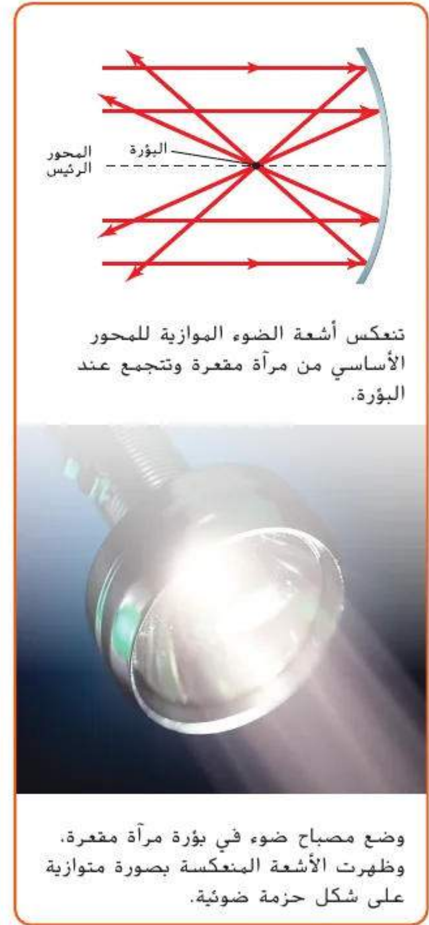
الشكل 11 في حال تتبع مسار الأشعة الضوئية من البؤرة إلى المرآة، ستنعكس عن السطح كأشعة متوازية.
