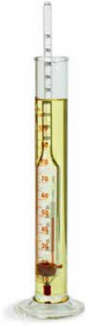
الشكل (15): أداة الهيدروميتر لقياس كثافة السوائل.
