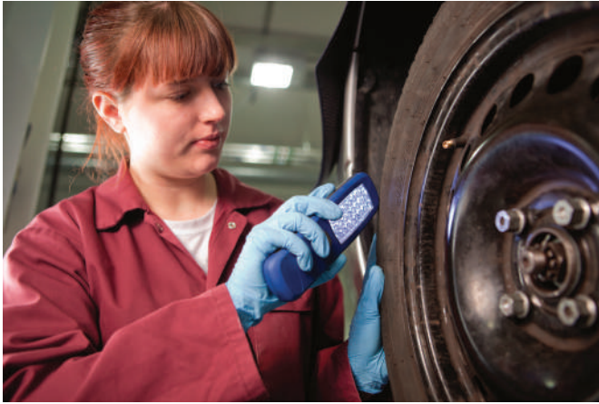
الشكل 31.76 الفحص البصري لتلف العجلة باستخدام مصباح الفحص.
