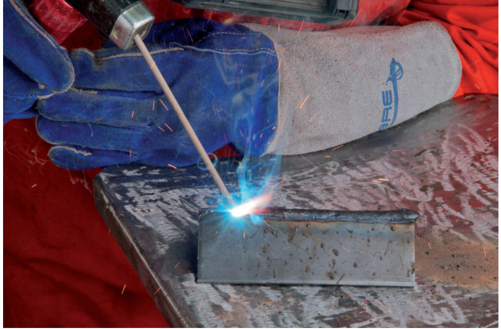
الشكل 11.3 إلكترود لحام وقوس كهربائي.
