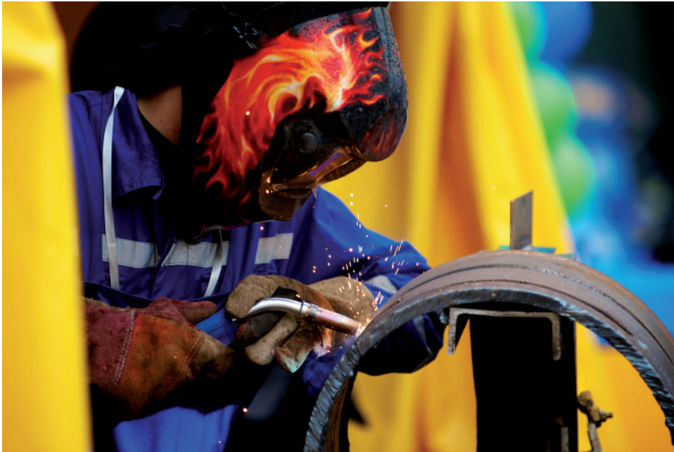
الشكل 11.5 يوفر استخدام مسدس اللحام بالغاز الخامل المعدني التحكم في عملية اللحام.
