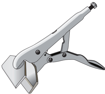
الشكل 11.17 لماذا تعتبر الألواح المسطحة لكماشة الإطباق والإمساك بالألواح جيدة في الإمساك بالصفحة المعدنية الفولاذية؟
