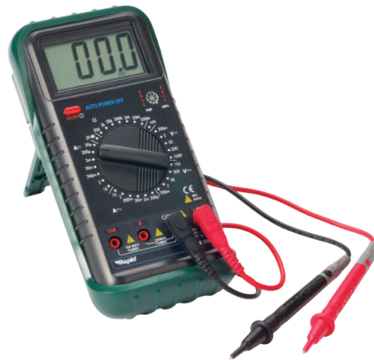
الشكل 22.39 مقياس متعدد الأغراض نموذجي وأسلاك اختبار.
