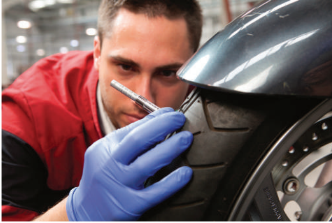
الشكل 31.79 قياس عمق مداس الإطار.
