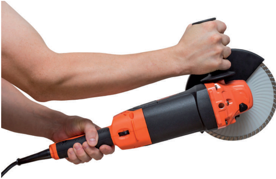
الشكل 11.61 امسك المنشار الكهربائي بإحكام مستخدماً كلتا يديك.
