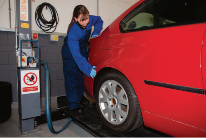
الشكل 31.86 فحص المخدمات الخلفية أثناء وجود المركبة على الأرض عن طريق رجّ في كل زاوية.
