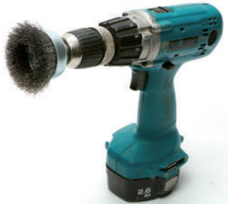
الشكل 11.21 تأتي فرش الأسلاك بأشكال وأحجام عديدة ويمكن تركيبها على الأدوات اليدوية لزيادة قوة التنظيف.
