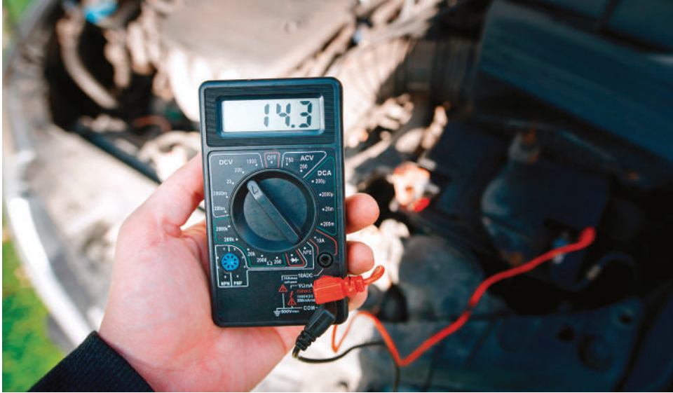
الشكل 31.89 مقياس متعدد لقياس مستوى جهد البطارية.
