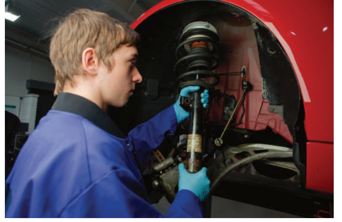
الشكل 31.85 استبدال تركيبة الساق النابضية.
