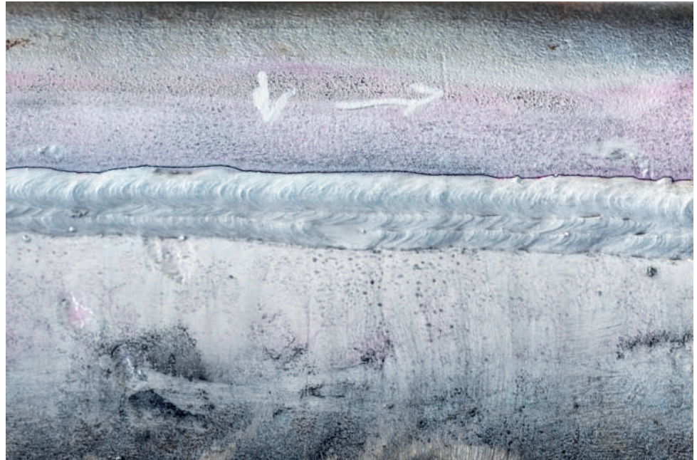
الشكل 11.58 يكشف اختبار الجسيمات المغناطيسية عن وجود تشقق طولي بجوار اللحام.
