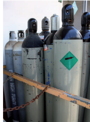
الشكل 11.10 يتم تخزين غاز الحجب بشكل آمن في قفص. يخبرك لون الأسطوانة بالمحتوى.
