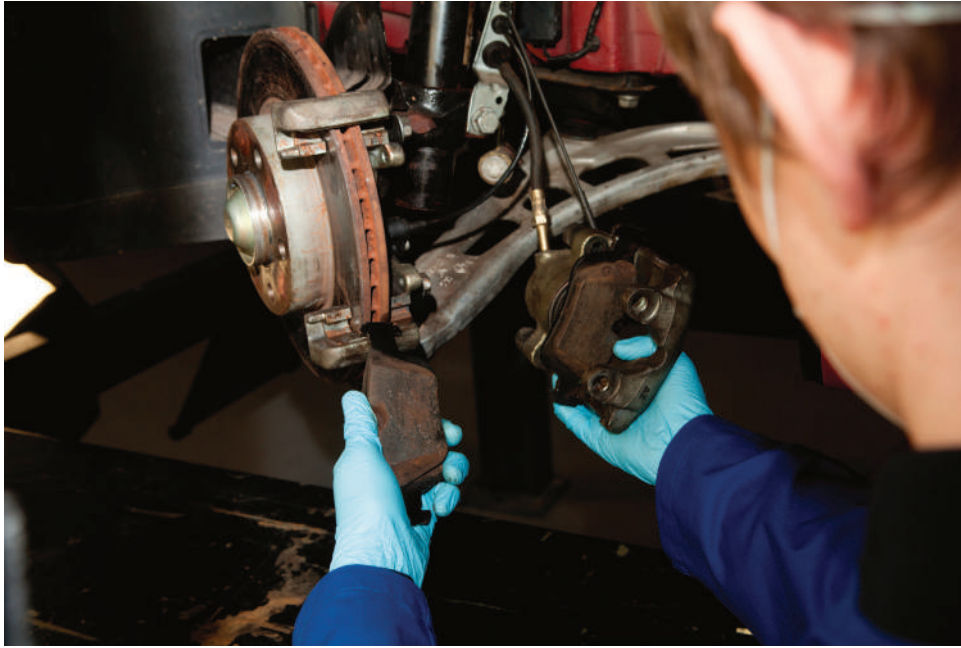
■ الشكل 31.87 إزالة وسادات الفرامل وفحصها.
