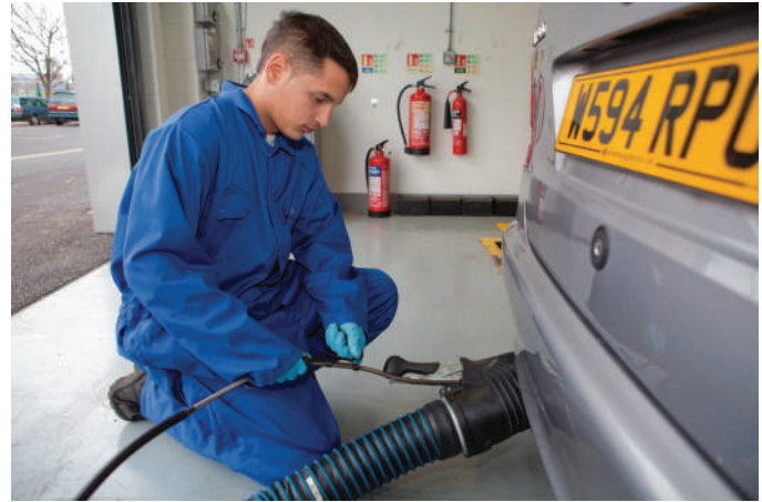
الشكل 31.42 إدخال مسبار العادم في أنبوب العادم بذيل السيارة.
