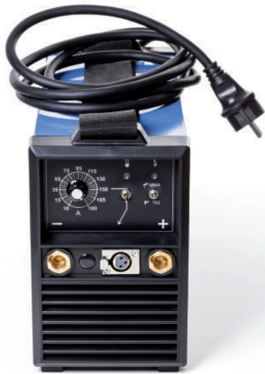
الشكل 11.22 مثال على أحد الأنواع العديدة المختلفة لماكينات اللحام بالقوس المعدني اليدوي "بنسبة اللحام" - تحتوي جميعها على مقبض (مثل ذلك الموجود في الزاوية اليسرى العليا)، والذي يستخدم للتحكم في الأمبير
