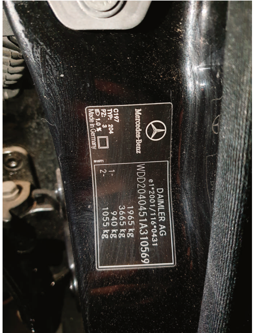
الشكل 31.3 مثال لرقم التعريف داخل مركبة.
