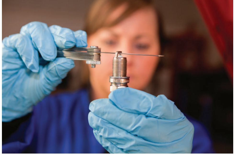
الشكل 31.59 في يقوم بفحص فجوة شمعة الإشعال باستخدام مقياس استشراري.
