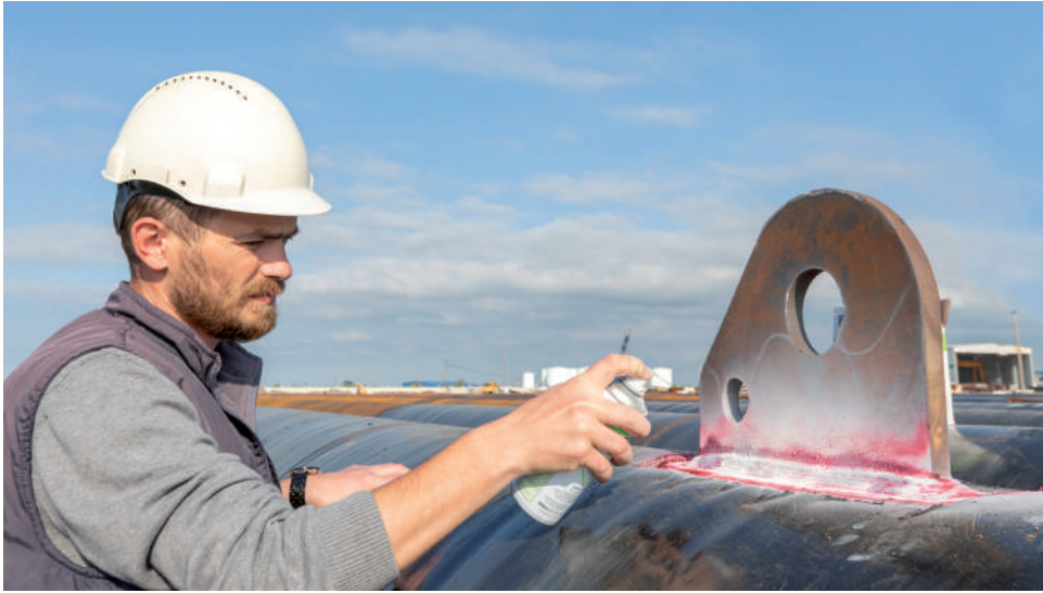
الشكل 11.56 يتم الكشف عن الشقوق والعيوب الأخرى غير المرئية للعين البشرية أثناء اختبار اختراق السائل.
