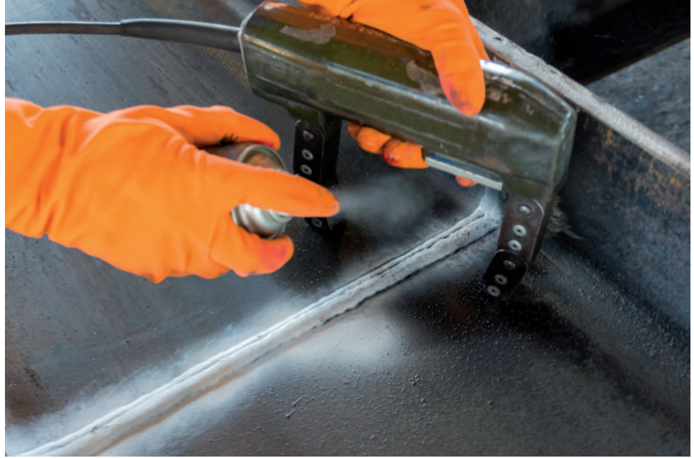
الشكل 11.57 يمكن أيضًا توفير الجسيمات المغناطيسية في شكل أيروسول.
