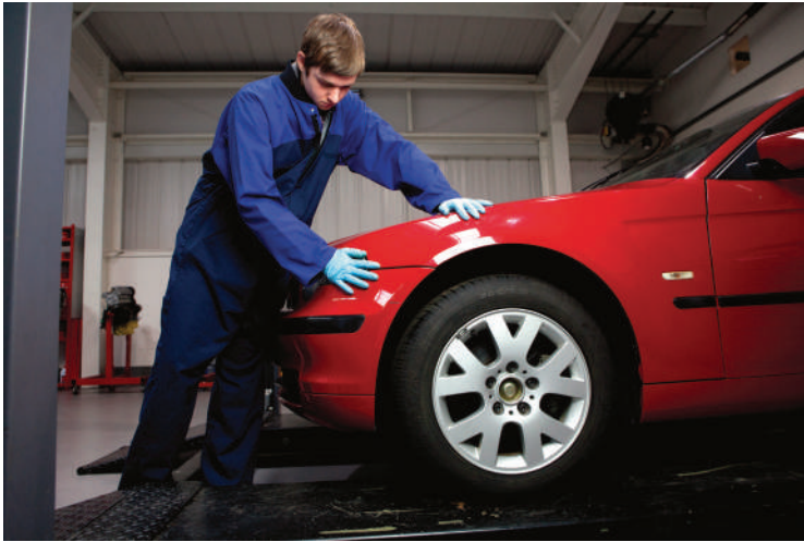
الشكل 31.84 في يقوم بتدوير المركبة للخلف وللأمام للسماح باستقرار نظام التعليق.
