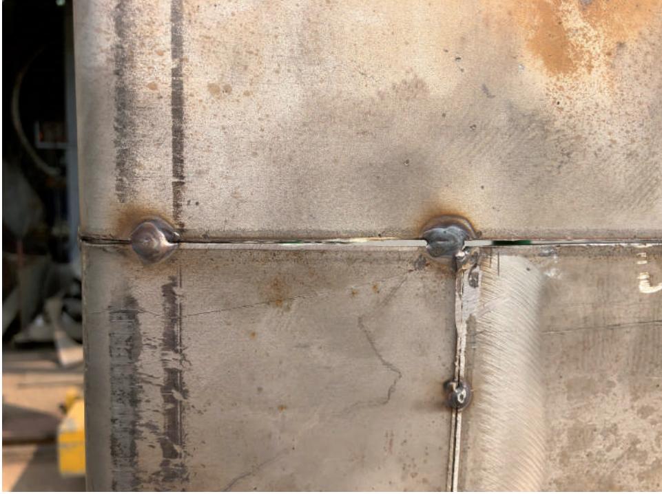
الشكل 11.35 نقاط صغيرة من اللحام "النقطي" تثبت الأجزاء المعدنية معاً قبل اللحام.
