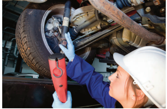
الشكل 31.75 الفحص البصري للمخمدات للتسرب والتآكل.
