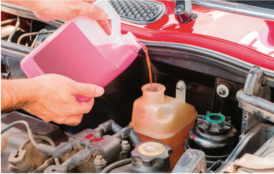
الشكل 31.60 تغيير سائل تبريد المركبة.
