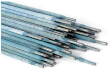
الشكل 11.6 أعواد الإلكترود للحام بالقوس المعدني اليدوي. يجب تخزينها بأمان في حاوية لإبقائها جافة وبعيدة عن الرطوبة.
