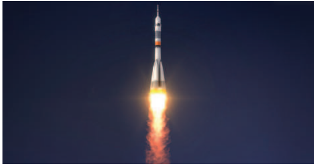
الشكل 4-5 يتم دفع الصاروخ عن طريق الهيدرازين ورباعي أكسيد ثنائي النيتروجين.
