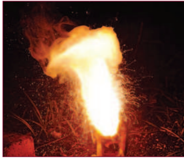
الشكل 11-7 يُستخدم تفاعل الثيرمايت لصهر الفلزات.
