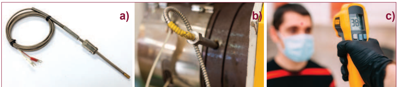
الشكل 5-35 (a) مُزدوج حراري مُثبت في وعاء تفاعل (c) بيرومتر يُستخدم لقياس درجة حرارة الجسم.
