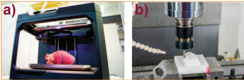
الشكل 44-6 (a) الطباعة الثلاثية الأبعاد لقلب الإنسان، (b) تصنيع قطعة بلاستيكية بالتحكم الرقمي من خلال استخدام الحاسوب.
