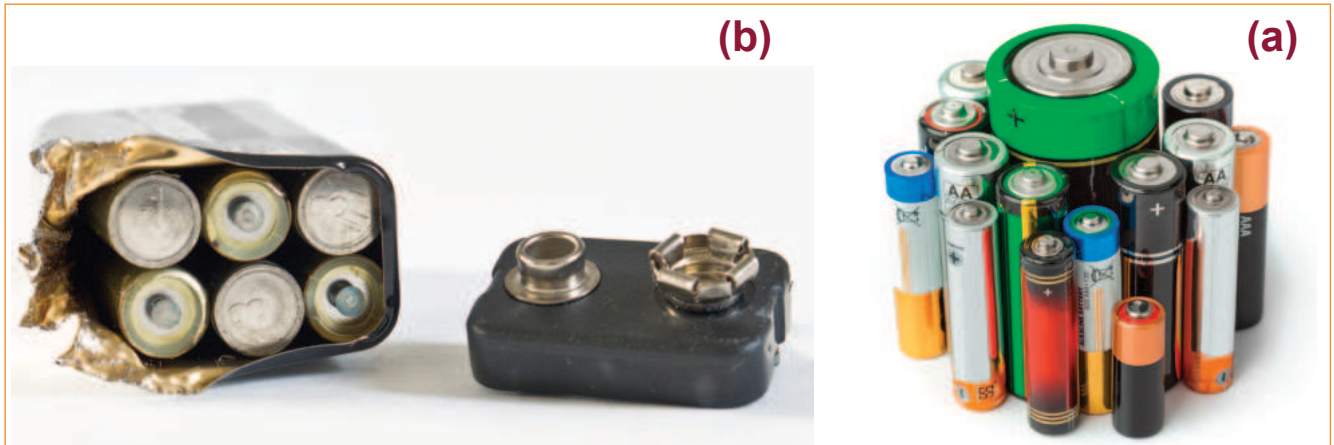
الشكل 4-9 (a) خلايا مفردة ذات جهد كهربائي 1.5 V (b) بطارية متعددة الخلايا ذات جهد كهربائي 9 V.
