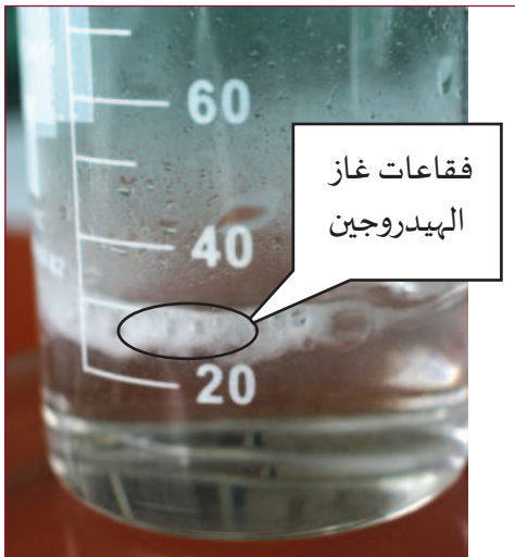
الشكل 16-3 تنتج فقاعات غاز الهيدروجين عندما يتفاعل فلزّ المغنيسيوم، Mg، مع حمض الهيدروكلوريك، \text{HCl}_{(aq)} .
