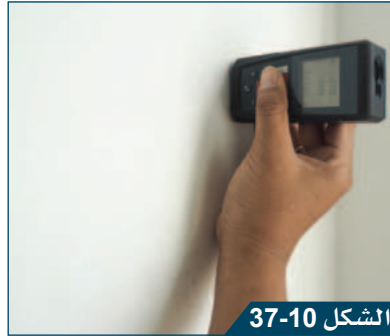
جهاز قياس المسافة باستخدام موجات فوق صوتية.
