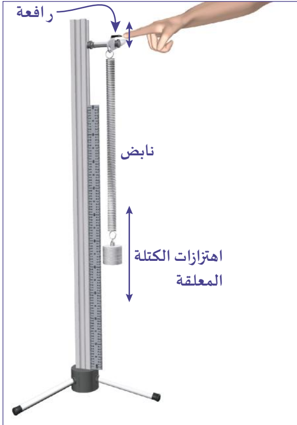
الشكل 2-35 اهتزاز كتلة معلقة في نابض.
