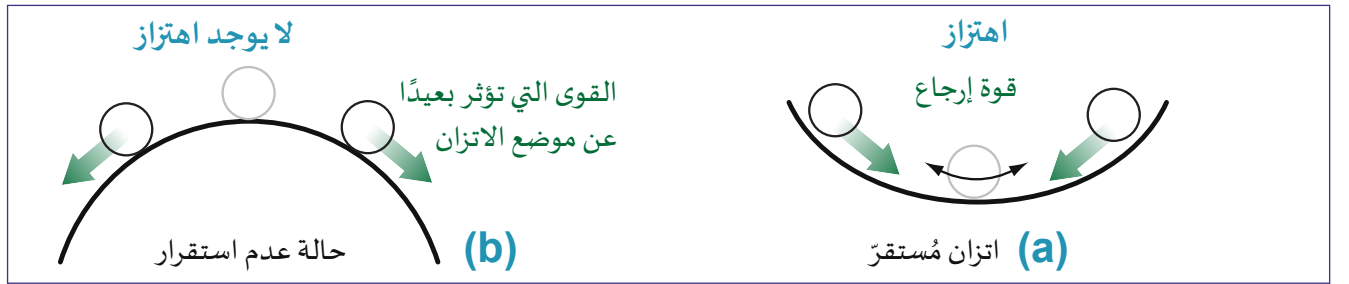
الشكل 3-2 (a) اتزان مُستقر (b) حالة عدم استقرار
