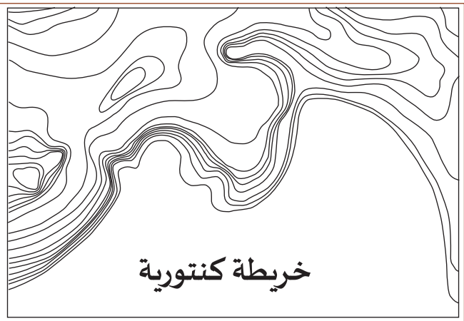
الشكل 21-1 سطح ذو كتورات طبقية وخريطة كنتورية.
