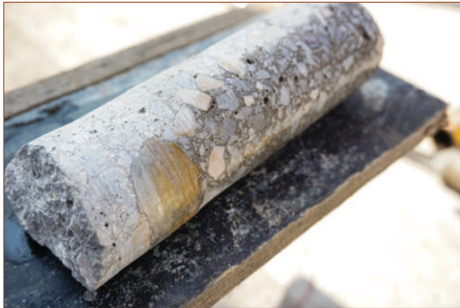
الشكل 30-3 العينة الجوفية هي مقطع من الصخور التي تقع تحت سطح الأرض حيث تُستخرج بواسطة حفارة مجوّفة.
