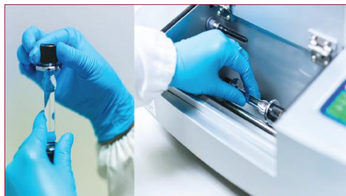
الشكل 31-3 البولاريومتر المستخدم في المختبرات الكيميائية.
