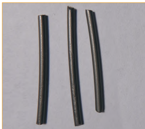
الشكل 17-2 سلك قياس ثقيل من التيتانيوم.
