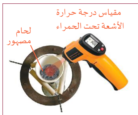
الشكل 1-14 يستخدم جهاز قياس درجة الحرارة بالأشعة تحت الحمراء لقياس درجة الانصهار.
