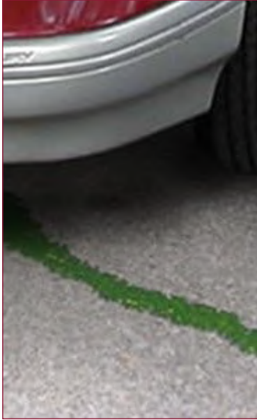
الشكل 1-4 تسرب سائل تحت السيارة.
