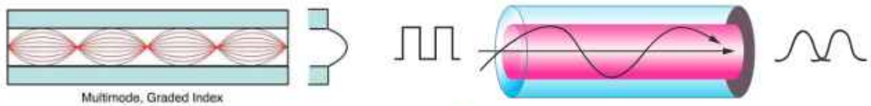
الشكل (31): الليف المُتعدّد الأنماط بمعامل انكسار مُتدرّج.
