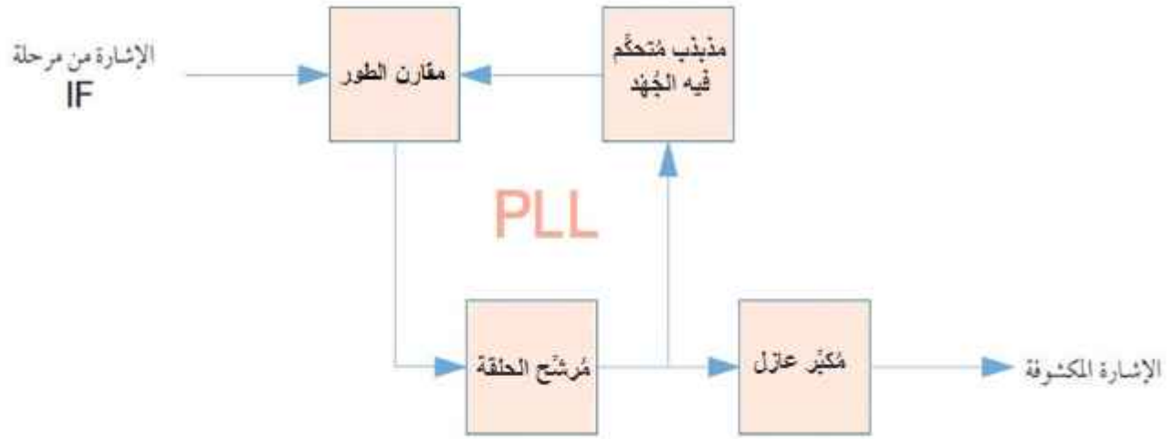
الشكل (17): المخطط الصندوقي لحلقة الطور المغلقة.
