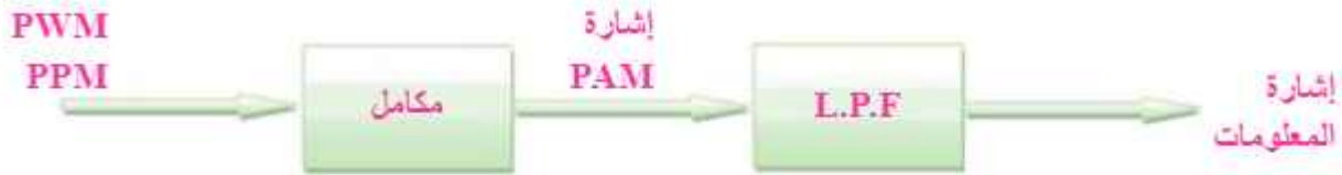
الشكل (19): كشف إشارة تضمين عرض النبضة (PWM)، وموقع النبضة (PPM).
