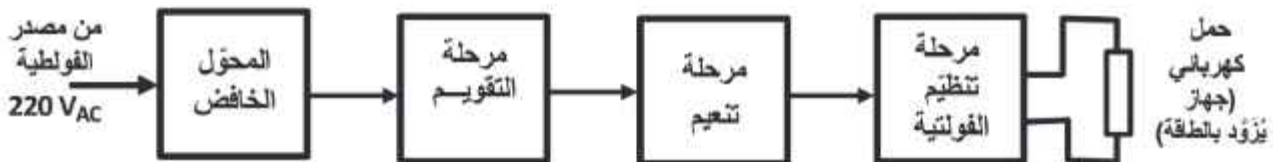
الشكل (2): مصدر تغذية بالتّيار المباشر يحوّل من (AC) إلى (DC)
