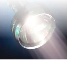
وضع مصباح ضوء في بؤرة مرآة مقعرة، وظهرت الأشعة المنعكسة بصورة متوازية على شكل حزمة ضوئية.
