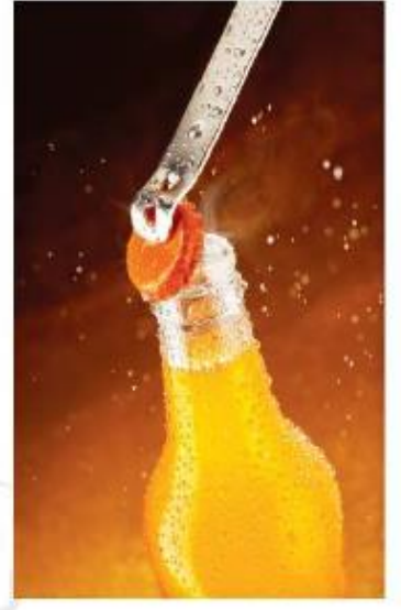
الشكل 16 إن فتاحة الزجاجات هي آلة تنقل الطاقة من يدك إلى غطاء الزجاجة.
