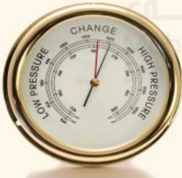
الباروميتر يستخدم لقياس ضغط الهواء.
