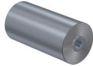
الشكل 4.4 يمكن لف الرقائق الفلزية وطبقة المايكلار الموضحة في الشكل 4.3 بطبقة عازلة لإنتاج مكثف ذي شكل هندسي مدمج.
