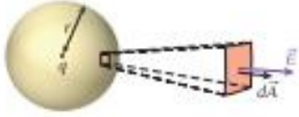
الشكل 2.29 سطح جاوسي كروي نصف قطره r يحيط بشحنة Q . يوضح الشكل نظرة عن قرب لمنصر سطح تفاضلي مساحته dA .
