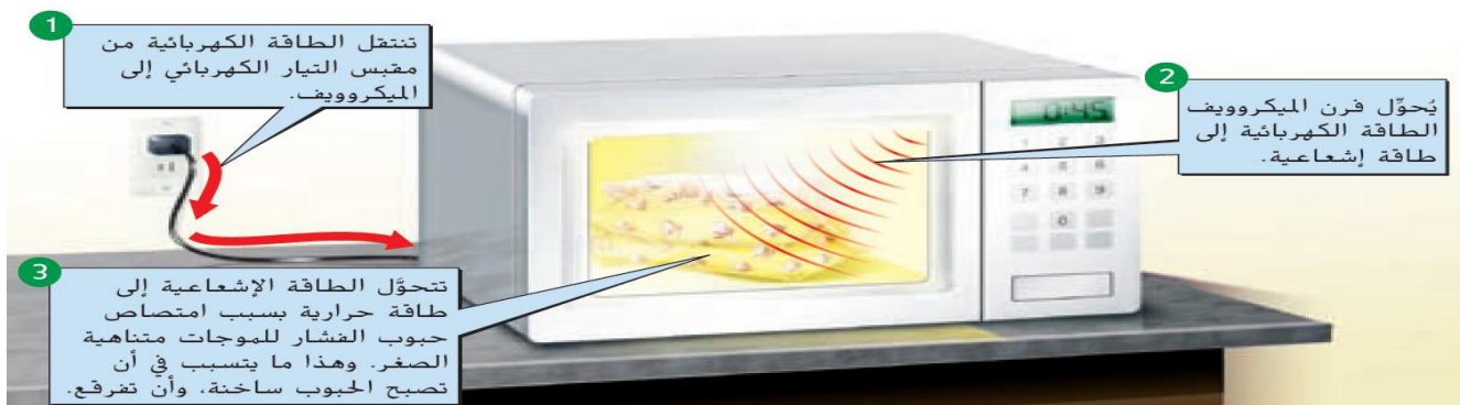
الشكل 5 تتغير الطاقة من شكل إلى آخر عند استخدام فرن الميكروويف لصنع الفشار.
