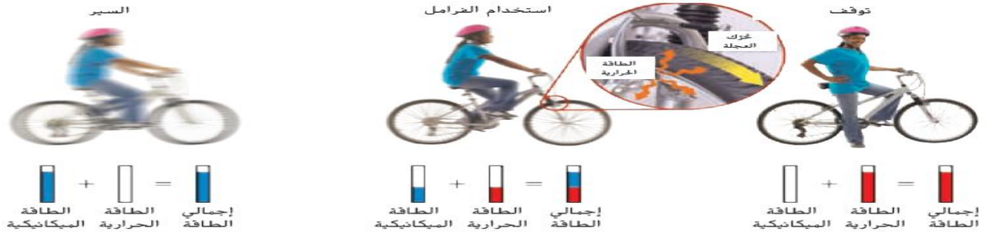
الشكل 7 عندما تستخدم الغتاة الفرامل، يحوّل الاحتكاك بين وسائد فرامل الدراجة وإطاراتها الطاقة الميكانيكية إلى طاقة حرارية. وعند تحوّل الطاقة الميكانيكية إلى طاقة حرارية، تتباطأ الدراجة، لكن لا يتغيّر إجمالي كمية الطاقة.
